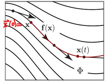
Fluss:  $\vec{\Phi}: I \times M \rightarrow M, (t, \vec{x}) \mapsto \vec{x}(t) \equiv \vec{\Phi}_t(\vec{x})$  (3)
