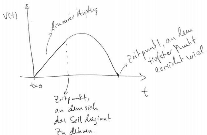
Abbildung 1: Skizze der Geschwindigkeit des Springers als Funktion der Zeit.
