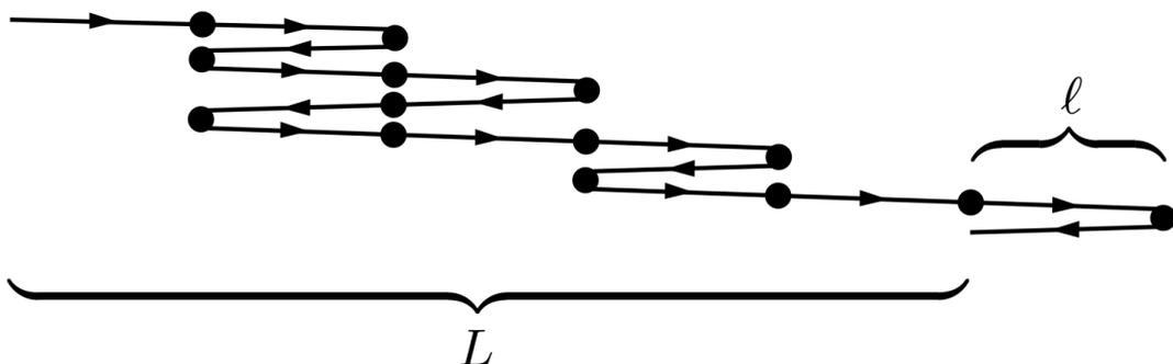
Nehmen Sie an, dass jedes Glied nur zwei mögliche Zustände besitzt, es zeigt entweder nach links oder nach rechts. Die Gesamtlänge  $L$  des Gummibandes ist die Netto-Distanz vom Beginn
