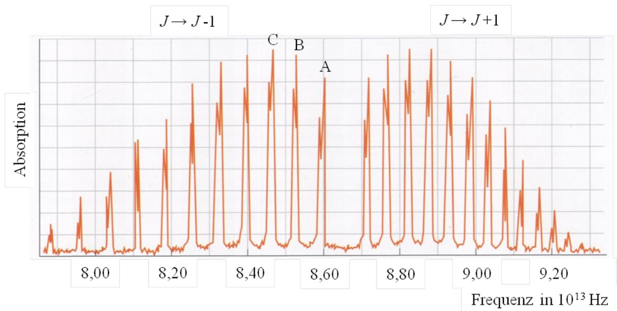
Die Abbildung oben zeigt ein gemessenes Rotationsschwingungsspektrum von HCl-Gas. Hierbei bezeichnet  $J$  die Rotationsquantenzahl. Der Schwingungsübergang findet vom Zustand mit der Schwingungsquantenzahl  $\nu = 0$  zu  $\nu = 1$  statt.
